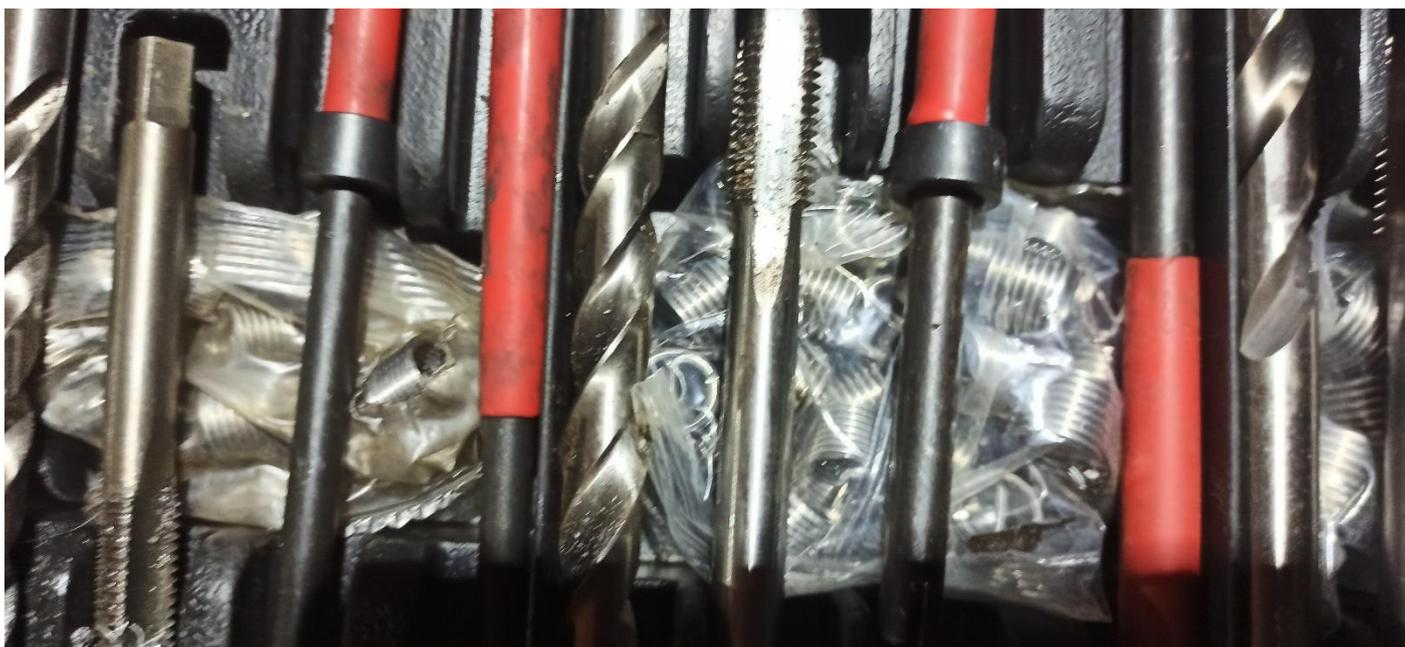
Сверлим сверлом, нарезаем мечником резьбу, потом вкручиваем стальную вставку, потом вкручиваем уже шпильку.
